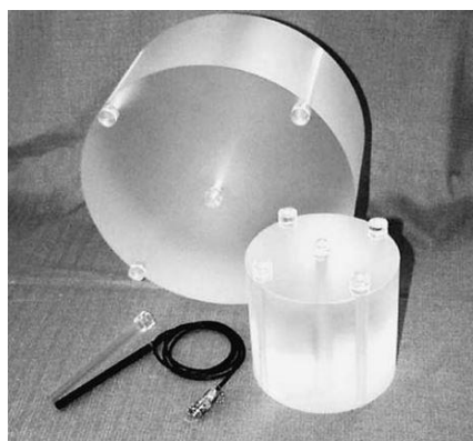
Слика 28: Стандардни цилиндрични фантоми који се користе у одређивању СТ дозних индекса
