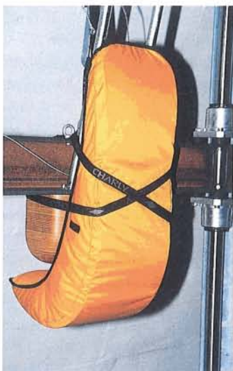
Nur zum Vergleich unterschiedlicher Schaumstoffmaterialien ist ein Versuch mit dem Protektor ohne Gurtzeug sinnvoll.
