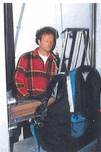
Ein Hersteller befestigt sein Gurtzeug am Fallgewicht der Prüfvorrichtung. Anschließend wird das Gewicht mit dem Gurtzeug durch einen Elektromotor hochgezogen und der Versuch ausgelöst.
