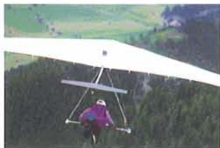
Erstmals zu sehen »Flügelchen« zur Erhöhung der Tuck-Sicherheit der Turmlosen
