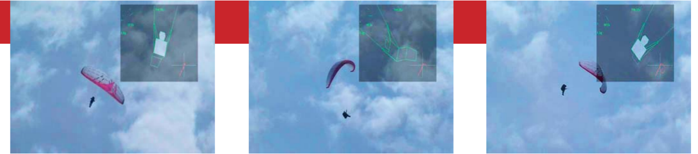
Die DHV-Testpiloten arbeiten, zusammen mit einem Messtechnik-Ingenieurbüro, an einer digitalen Aufzeichnungstechnik für dynamische Manöver, wie z.B. Steilschirmen. Dabei wird (siehe Bilder), die Lage des Piloten im Raum grafisch aufgezeichnet, sowie die Messwerte für G-Kräfte, Sinkgeschwindigkeit sowie den Nickwinkel der Kappe und zusätzlich die GPS-Daten. Diese Technik soll helfen, das Manöver Steilschirmen objektiver zu testen. Gleitschirme, die hohe Anforderungen an den Piloten stellen, weil sie in der Steilschirmen rasch hohe G-Kräfte aufbauen und dynamisch „auf die Nase gehen“, sollen damit besser von Schirmen unterschieden werden können, die sich in der Steilschirmen gutmütig verhalten.
