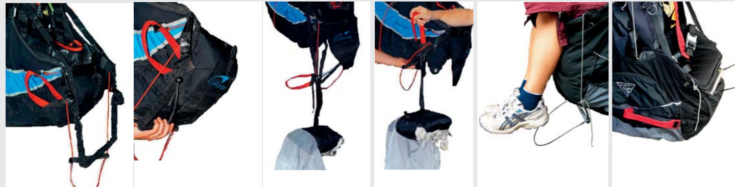
Bild 1: Beschleuniger (rot) und Beinstrecker (schwarz) in entlasteter Stellung (Beschleuniger in Tragegurte eingehängt).
