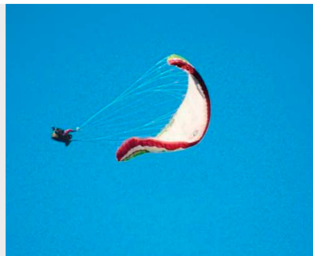
Ist die Entlastung auf der zuvor offenen Seite so groß, kann es auch zu derartigen Einklappen führen. In diesem Fall hatte es wieder die positive Eigenschaft des Abbremsens.
