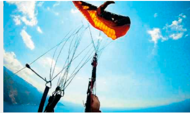
Bild 2 | Verhänger von hinten kommend. Meist ausgelöst durch Überbremsen der offenen Seite nach einem Klapper. Hier hilft zuerst ein Freigeben der Bremsen, um den Schirm kontrolliert zum Fliegen zu bringen. Sollte sich der Verhänger nicht lösen, hilft meist die Stabiloleine.
