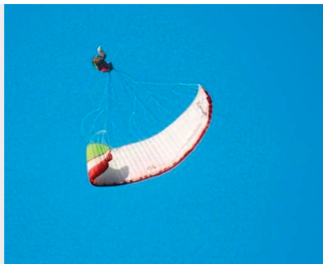
Das Vornicken nach dem Klapper auf der rechten Schirmseite ist sehr groß. Der Pilot wird regelrecht ausgehebelt, was zu einer Entlastung des linken Flügelteils führt. Dieser rollt sich ein und bremst die Rotation.
