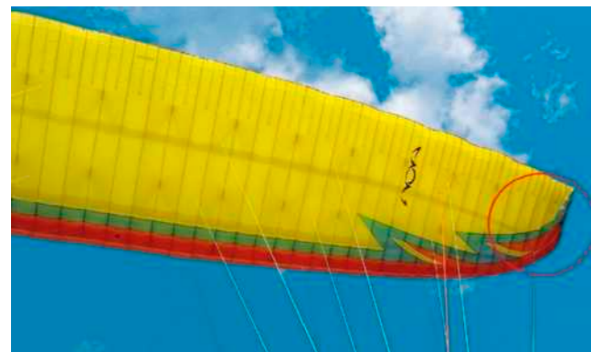
Das Bild oben zeigt eine Stabiloleine mit deutlicher Vergabelung im Galeriebereich. Ein Öffnen von Verhängern kann damit erschwert werden.
