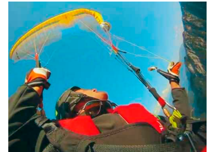
Lösungsversuch mit der Stabiloleine. Flugrichtung stabilisieren und Verhänger lösen gestaltet sich in der Praxis oft schwieriger als in der Theorie. Im Zweifelsfall den Notschirm auslösen!
