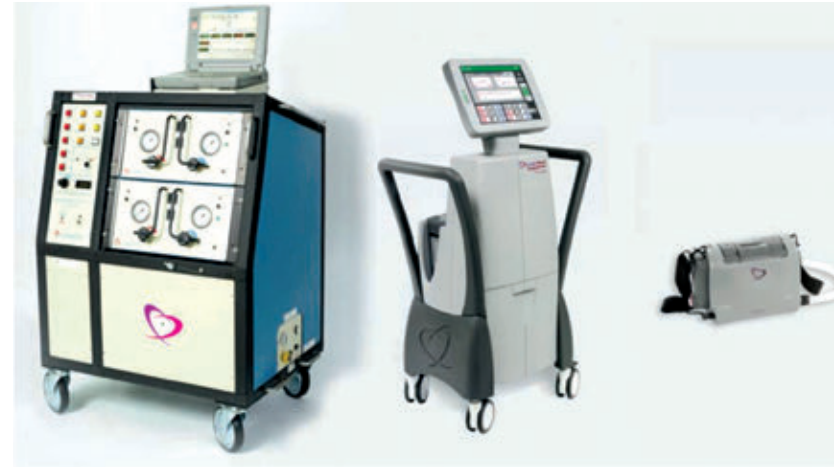
Abb. 28: Technische Evolution der Antriebseinheiten des SynCardia-TAH: Die Abbildung erlaubt einen Größenvergleich zwischen den im Bild von links nach rechts dargestellten Konsolen „Big Blue“, Companion-Driver und Freedom-Driver.
