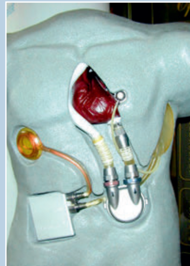
Abb. 6: Das komplett implantierbare LionHeart aus dem Jahr 1999.
