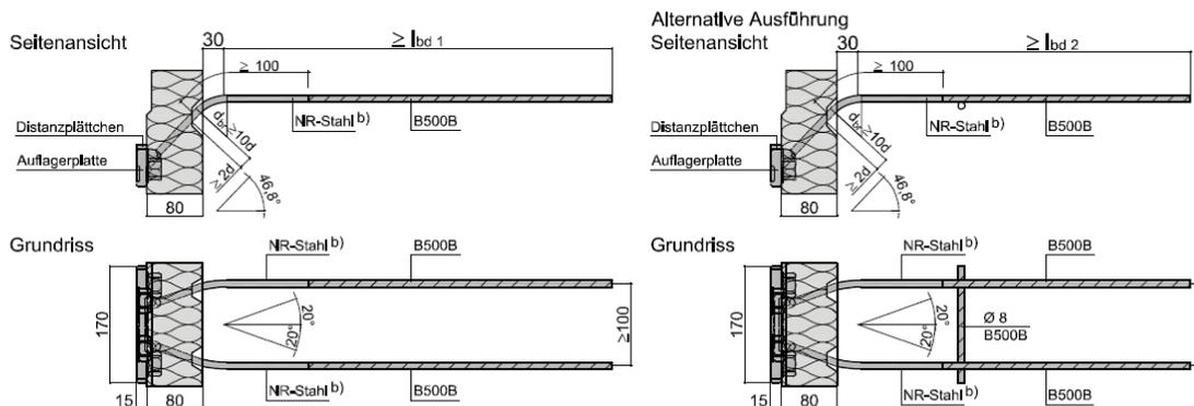
Abb. 20a bis 20d: Querkräftstäbe 2 Ø d inkl. Auflagerplatte
