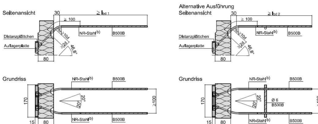
Abb. 14a bis 14d: Querkraftstäbe 2 Ø 8 inkl. Auflagerplatte
