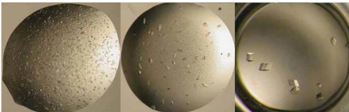
Figura: Cristallizzazione allo stereo microscopio di allume di rocca.
