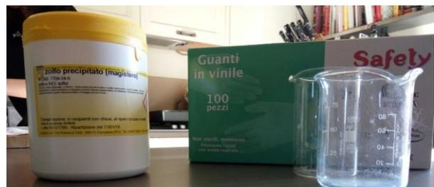
Abbiamo fuso a  $60^\circ\text{C}$  la polvere di zolfo (abbiamo scelto lo zolfo perchè non è tossico e quando fonde non emette gas o vapori in grande quantità volatilizzando) e abbiamo suddiviso il fuso in due becker messi ciascuno a bagno in una teglia riempita con acqua, una bollente e l'altra gelida.
