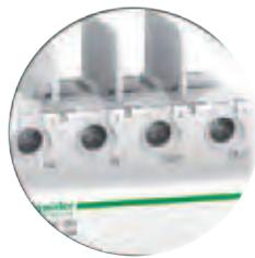
Lasttrennschalter C60NA-DC für eine Betriebsspannung von bis zu 1000 V DC werden für das Freischalten von PV-Strängen unter Last eingesetzt.
