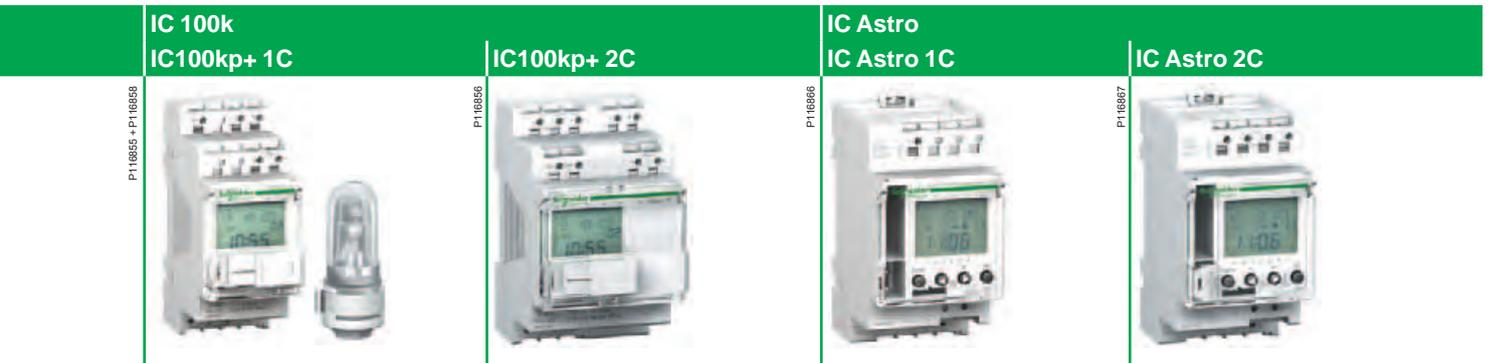
Dämmerungsschalter IC 100kp+ 1C/2C werden zur Helligkeits- und zeitabhängigen Lichtregelung eingesetzt. Fällt die Helligkeit unter den eingestellten Ansprechwert (Dämmerungsfunktion: IC) und erlaubt das Zeitprogramm das Schließen des Relais (Zeitschalterfunktion), wird der Beleuchtungsstromkreis aktiviert.
