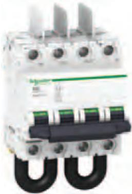
Der Lasttrennschalter SW60-DC wird für die Trennfunktion in der Einspeisung in einer Photovoltaikanlage vor dem Wechselrichter auf der DC-Seite eingesetzt (siehe Anwendungsschema Seite 4/44). Er ist für Gleichspannungen bis zu 1.000 V DC ausgelegt.
