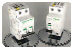
Mit Leitungsschutzschaltern iC60 als Versicherung für den Überlastschutz können Sie den FI iID jetzt mit Nennstrom vorsichern. Die übliche Reduzierung des Vorsicherungs-Nennstromes wie bei der Verwendung von Schmelzsicherungen ist damit nicht mehr nötig.
