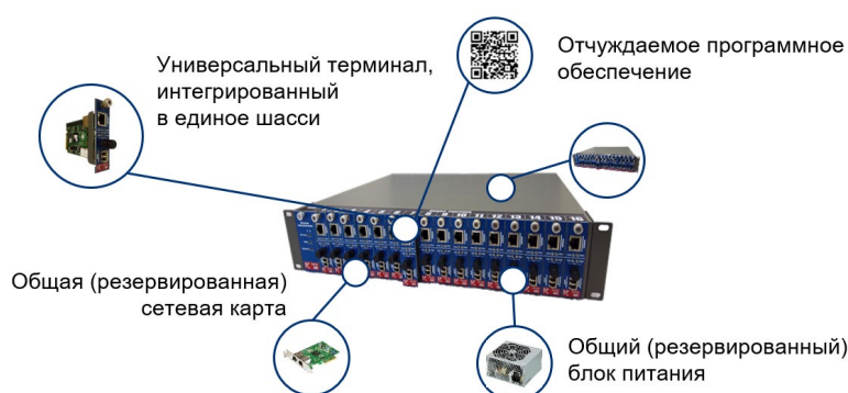
Рис. 16.1. Принцип устройства универсальной программно-аппаратной платформы (кластер)
