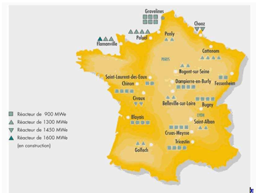
Figure 85 bis : Répartition des installations nucléaires de base (INB) destinées à produire de l'électricité. Source : Ministère de l'Ecologie, du Développement Durable et de l'Energie.
