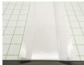
Nun ist das Papier so gefaltet, dass Sie die Lackfolie positionieren können ohne das diese eine Klebeverbindung zur Platte herstellt. Jetzt müssen Sie das aufzutragende Material gut positionieren und Ausrichten!
