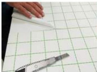
Anschneiden des Silikon-Abdeckpapiers damit dieses später aufgeklappt werden kann.
