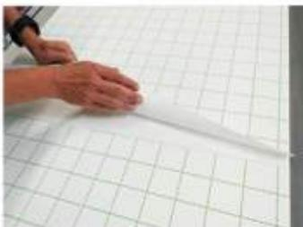
Silikon-Abdeckpapier vorsichtig bis zum Ende der Platte wegklappen. Orientieren Sie sich an dem aufgedruckten Raster.
