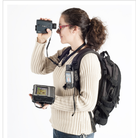
Exemple du matériel utilisé pour la cartographie des milieux naturels (technologie Field-Map: l'ordinateur PC, GPS, laser télémètre).
