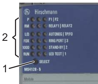
Abb. 15: Taster „SELECT“ am Grundmodul 1 – Taster „SELECT“ 2 – Anzeige-LEDs
