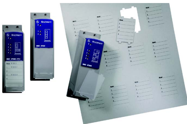
Abb. 9: Anbringen der Beschriftungsetiketten
