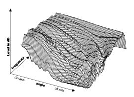
caja) a una respuesta dominada por los bajos fuera del eje (detrás de la caja). Pueden visualizarse los puntos de medida como el "ecuador" de la esfera.
