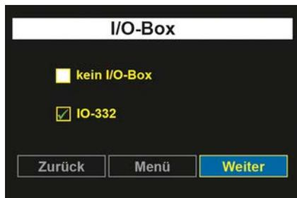
Auswahl des Typs der bei Ihnen installierten I/O-Box (optional). Aus Sicherheitsgründen wird die Kommunikation zwischen der Türsprechanlage und der I/O-Box durch einen PIN-Code geschützt. Ohne den korrekten PIN-Code bleibt die I/O-Box ohne Funktion. Näheres zum Anschluss der I/O-Box entnehmen Sie bitte der Bedienungsanleitung der entsprechenden Box.
