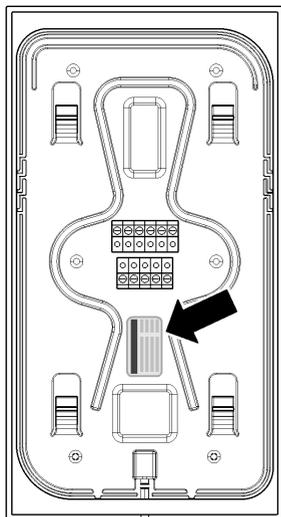
Auf dem Typenschild befinden sich die Informationen zum Gerätetyp, Seriennummer und weitere Produktkennzeichnungen. Die Seriennummer finden Sie außerdem auf der Notfall-Pin-Karte (siehe Kapitel Notfall-PIN [► 13]).
