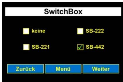
Auswahl des Typs der bei Ihnen installierten SwitchBox (optional). Aus Sicherheitsgründen wird die Kommunikation zwischen der Türsprechanlage und der SwitchBox durch einen PIN-Code geschützt. Ohne den korrekten PIN-Code bleibt die SwitchBox ohne Funktion. Näheres zum Anschluss der SwitchBox entnehmen Sie bitte der Bedienungsanleitung der entsprechenden Box.
