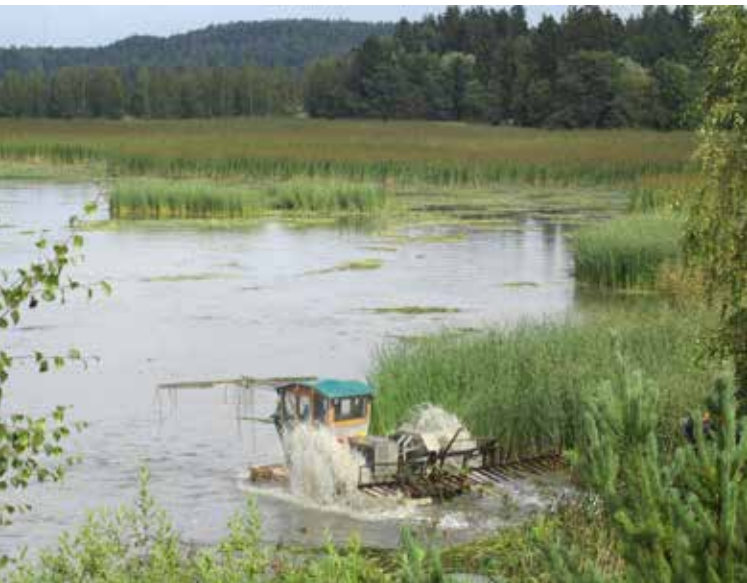
Paimionlahdella vesikasvillisuutta leikattiin Truxor-leikkuukoneella avovesialueen lisäämiseksi elokuussa 2012. Kuva: Marjo Perkonaja
