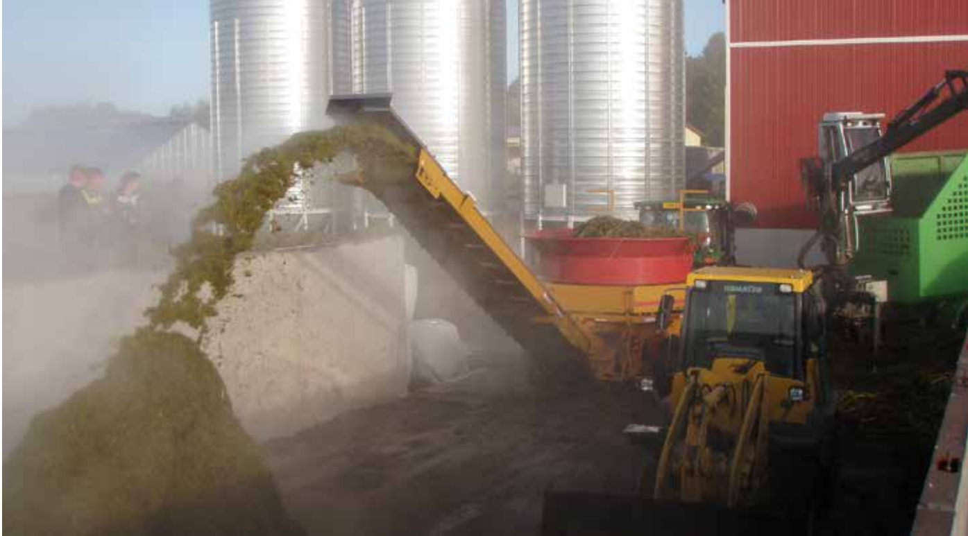
Paimionlahdelta elokuussa 2012 leikattu biomassa kuljetettiin kuorma-autoilla Ammattiopisto Livian Tuorlaan, missä ruoko silputtiin jatkokäyttöä varten HayBuster-silppurilla. Pieni osa tuoreesta silputusta ruokomassasta sijoitettiin koeluonteisesti peltoon kateaineeksi ja humusaineen lisääjäksi. Pääosa silputusta ruokomassasta jatkohyödynnettiin ammattiopiston biokaasulaitoksessa biokaasun raaka-aineena. Kuva: Marjo Perkonaja
