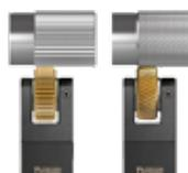
Wird mit einem Satz gefasten, diagonalen Hochgeschwindigkeits-Rändelrädern geliefert, TiN beschichtet, \* .8mm, \*\* 1mm, +++ Achtung: kann kleine Durchmesser verbiegen, zu hoher Druck bei großen Durchmessern
