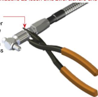
2. Zange zusammendrücken, die Verbindung wird bis zur ersten Raste gelöst. Mit dem dickeren Teil der Zange und erneutem Schließen wird auch die zweite Raste gelöst
