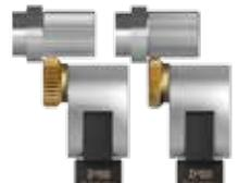
Wird mit einem Satz gefasten, diagonalen Hochgeschwindigkeits-Rändelrädern geliefert, TiN beschichtet, \* .8mm, \*\* 1mm, +++ Achtung: kann kleine Durchmesser verbiegen, zu hoher Druck bei großen Durchmessern
