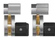
Wird mit drei Sätzen gefasten, diagonalen Hochgeschwindigkeits-Rändelrädern geliefert, TiN beschichtet, \*0.6mm 0.8mm, 1.3mm, \*\*1.6 mm, 1mm, 0.7mm, +++ Achtung: kann kleine Durchmesser verbiegen, zu hoher Druck bei großen Durchmessern
