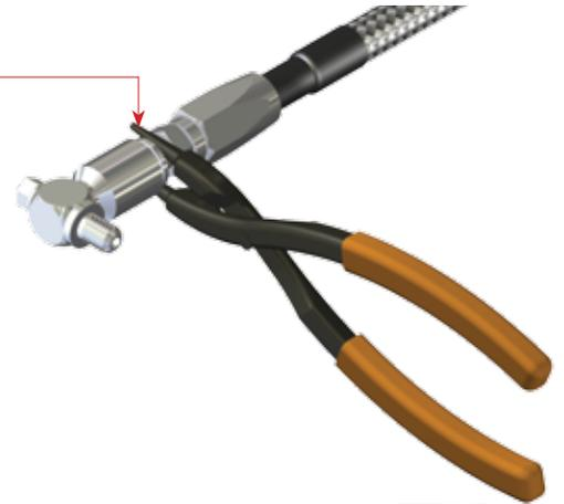
2. Zange zusammendrücken, die Verbindung wird bis zur ersten Raste gelöst. Mit dem dickeren Teil der Zange und erneutem Schließen wird auch die zweite Raste gelöst
