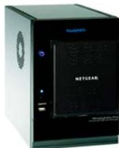
In seinem kompakten Desktop-Gehäuse bietet der ReadyNAS Pro Pioneer bis zu sechs Festplatten vom Typ SATA I oder SATA II in abschließbaren Hot-Swap-Einschüben Platz. Es stehen drei USB 2.0-Anschlüsse für USB-Laufwerke oder Drucker zur Verfügung. Pro Pioneer unterstützt bis zu 12 TB an Netzwerkspeicher, der problemlos erweitert werden kann, sobald größere Festplatten erhältlich sind.
