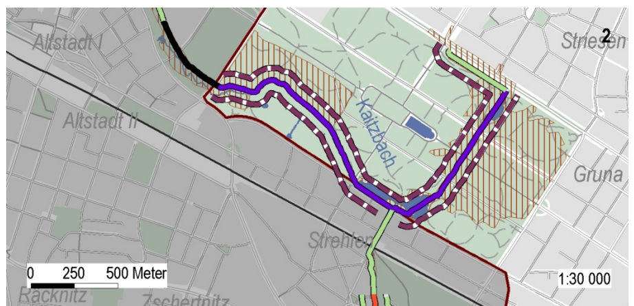
Abbildung 6.22-05.2 Bestehende und angestrebte Schutzgrade – Gewässer zweiter Ordnung – Ausschnitt Kaitzbach
