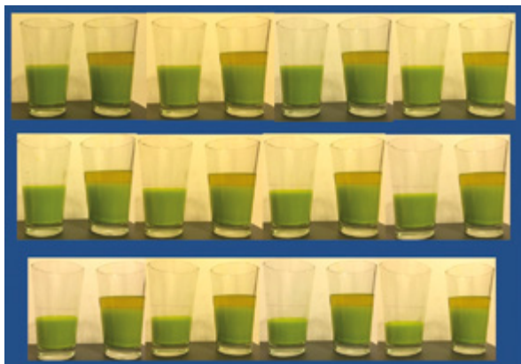
Figura 6. Prueba de vasos de agua con colorante y aceite de cocina. En el vaso que se colocó el aceite no se evaporó el agua, lo que comprueba que in vitro el aceite disminuye la evaporación del agua.
