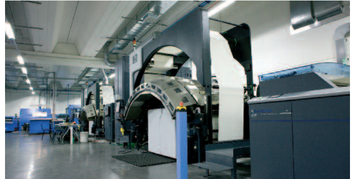
Zusammen mit einem Inline-Finishing-System von Müller Martini bildet die HP T300 Color Inkjet Web Press eine unabhängige Bücher-Produktionseinheit bei Rotolito Lombarda in Mailand.
