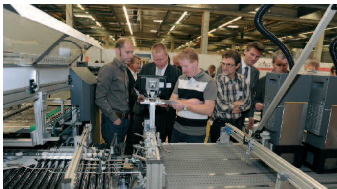
Im Rahmen der Heidelberg Postpress Commercial Informationstage 2011 ergänzten die im Heidelberg StahlFolder FlexoMailer installierten Kodak Prosper S5 Eindrucksysteme Mailings mit variablen Informationen und Adressen.
