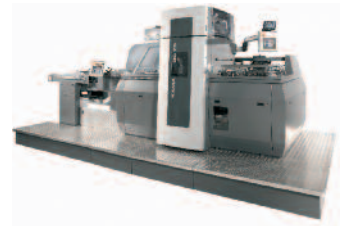
Der CombiStar Pro steuert die Feuchtmittelaufbereitung und die Farbwerktemperierung und enthält zusätzlich noch eine Freikühlung für weitere Energieeinsparung.
