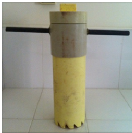
Figura 1.37. Corazonador utilizado para la extracción de sedimento.
