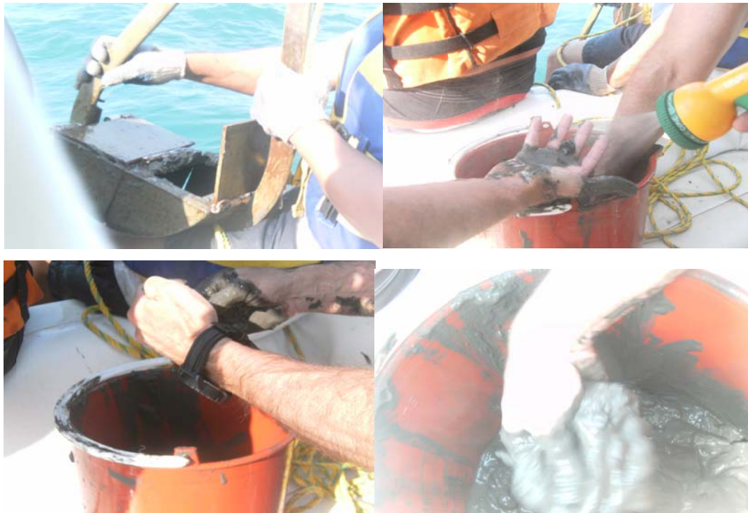
Figura 1.5. Extracción muestras de sedimento-tipo de grano predominante, cieno de textura viscosa.
