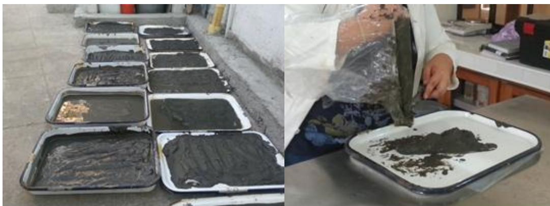
Figura 0.6. Extendido y secado de las muestras de sedimento en el laboratorio.
