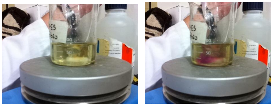
Figura 0.12. Determinación de carbonatos presentes en el sedimento mediante el proceso de titulación.
