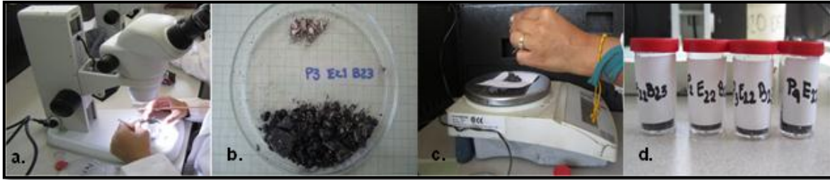
Figura 4.2. a. y b. Observación de las partículas de carbón y mecanismo de separación mediante estereoscopio, c. Pesaje del carbón aislado, d. almacenamiento del carbón acumulado.
