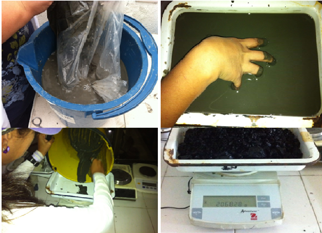
Figura 1.38. Procedimiento de decantación de las muestras, separación del carbón y pesaje.
