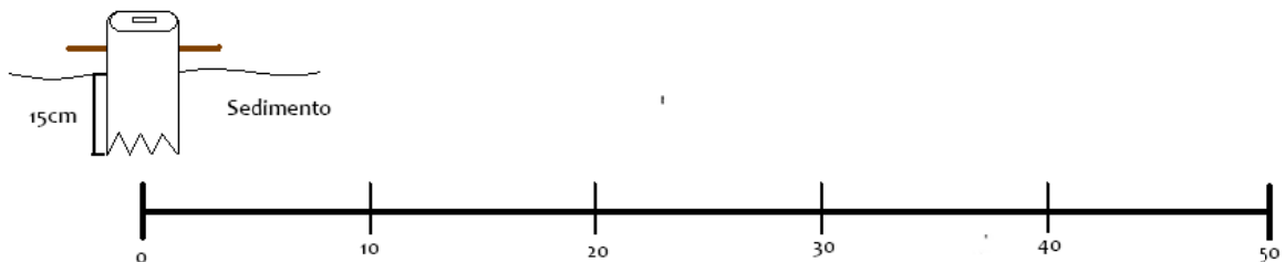
Figura 1.17. Esquema de metodología para la toma de muestras de sedimento por medio de un corazonador.
