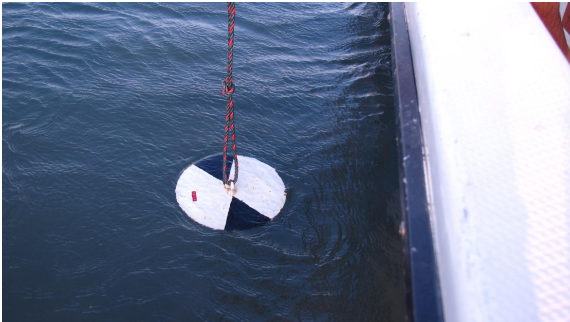
Figura 2.6. Disco Secchi utilizado para la determinación de perfiles de extinción de luz.
