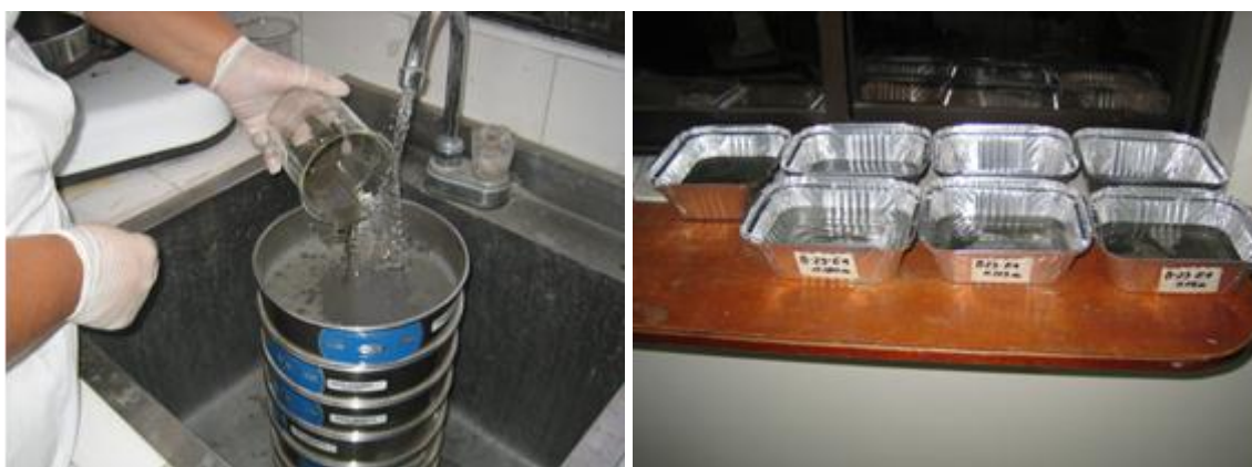
Figura 0.8. Tamizaje en húmedo y porciones de sedimentos finales de cada tamiz.
