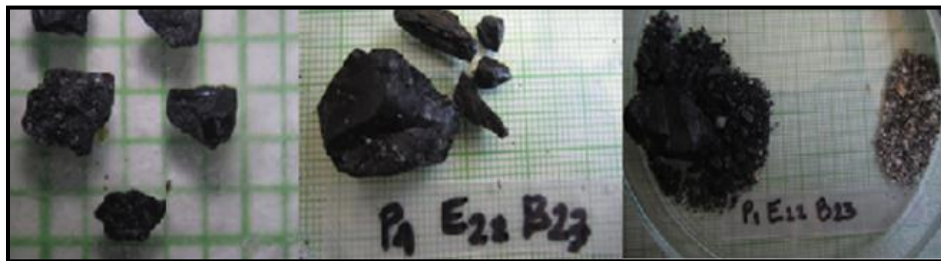
Figura 4.4. Apariencia del carbón mineral no quemado presente en muestras de sedimento analizadas.
