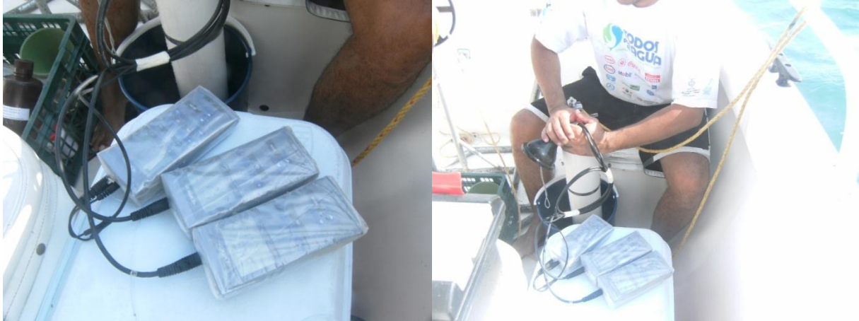
Figura 2.7. Toma de variables fisicoquímicas en campo haciendo uso de sondas multiparámetros WTW y botella oceanográfica Van Dorn.
