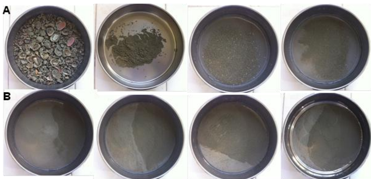
Figura 0.25. Resultado del tamizaje en seco de la muestra BR-E15. A. Contenido de sedimento en los tamices: izquierda a derecha 1.00 \mu , 500 \mu , 250 \mu , 180 \mu . B. Tamices de izquierda a derecha 125 \mu , 90 \mu , 63 \mu , <63 \mu .
