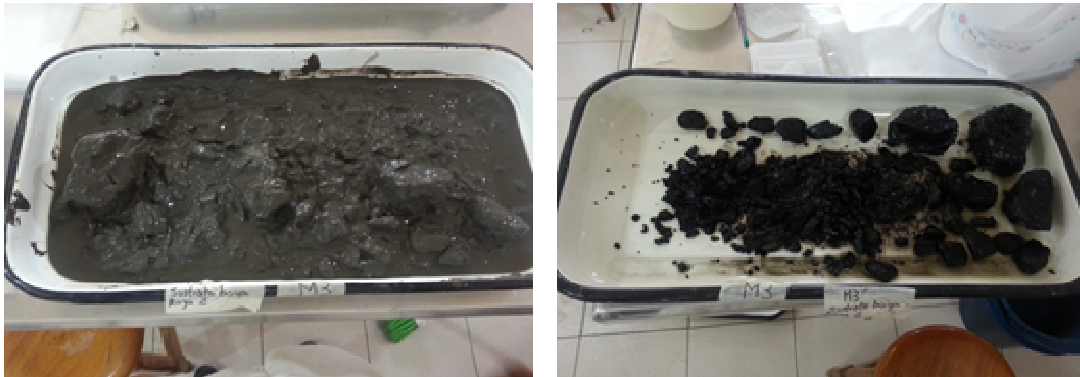
Figura 1.33. Muestra de sedimento con carbón embebido en donde se observan tres fracciones bien diferenciadas.
