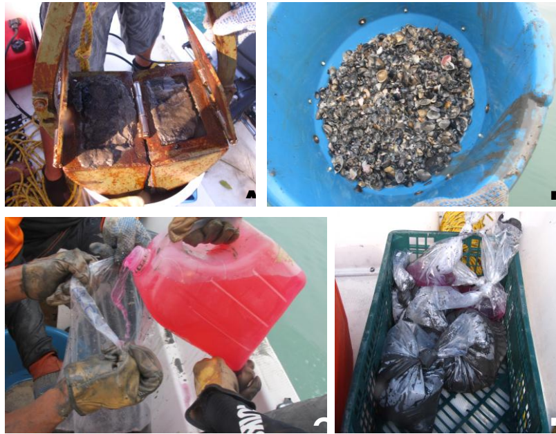
Figura 7.3. Metodología de muestreo de infauna A. draga con sedimento, B. muestra tamizada, C. fijación con formalina al 4 % y rosa de bengala como agente de tinción, D. muestras recolectadas.
