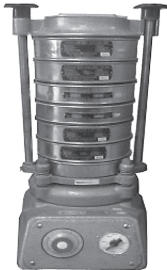
Figure 2 Laboratory cascade sieve Slika 2. Laboratorijsko kaskadno sito
