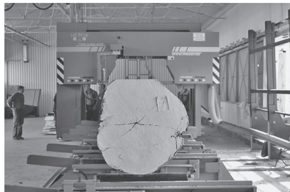
Figure 1 Horizontal log band saw Mebor HTZ -1000 Slika 1. Horizontalna tračna pila trupčara Mebor HTZ-1000
