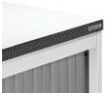
Bis 3 OH Gesamthöhe: Abdeckplatte Kunststoffschichtstoff, 25mm stark, abgerundete ABS-Umleimer
