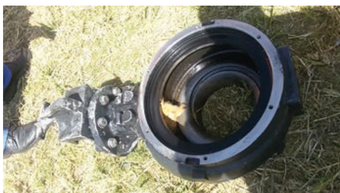
Foto: Nigrad, k. p., d. o. o. (zamašene in poškodovane črpalke naših črpališč)
