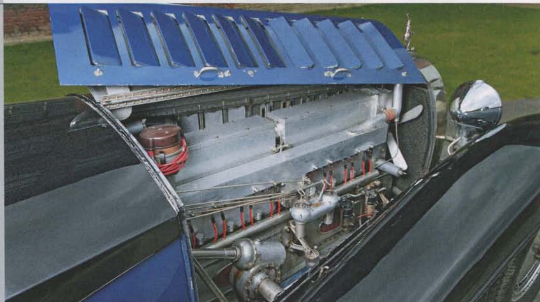
Ein Monument von Motor: 1,4 Meter lang, Zylinderkopf und Block aus einem Stück, knapp 14 Liter Hubraum, angeblich 300 PS, drei Ventile pro Zylinder (zwei Einlass), neun wassergekühlte Kurbelwellenlager, Doppelzündung
