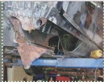
Auweiã: Am Schweller gab es große Löcher. Maic schweißte sie zu
