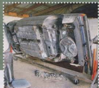
Auweiã: Am Schweller gab es große Löcher. Maic schweißte sie zu
