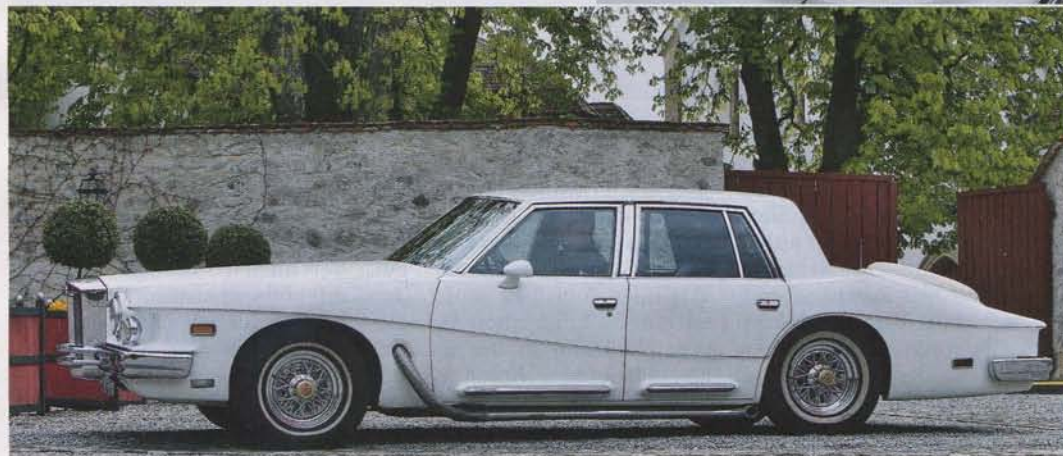
Man muss die Zeichen lesen können: Der Chrombesatz an den Türen zitiert die Form von Trittbrettern, die geschweifte Sicke die Kotflügel-Linie eines 30er-Jahre-Duesenberg. Die Reserverad-Abdeckung ist eine Hommage an den klassischen europäischen Geschmack - und enthält wirklich den Ersatzreifen
