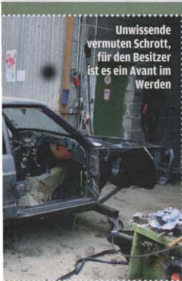
Auweiã: Am Schweller gab es große Löcher. Maic schweißte sie zu
