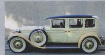
1928 Stutz BB: Reihenachtzylinder, 115 PS. Feinster Automobilbau, doch das Ende ist nah
