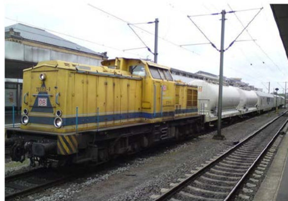
Abb. 38 chemische Vegetationsbeseitigung im Gleis (Spritzzug Fa. Bayer) Quelle: DB Netz AG/Michael Thomes
