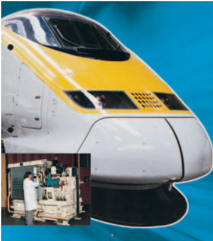
Σχ. 3.28: H/Z με νηξελοκίνητο - 3~εναλλακτήρα για ασύγχρονο ηλεκτροκίνητο τρένο.
