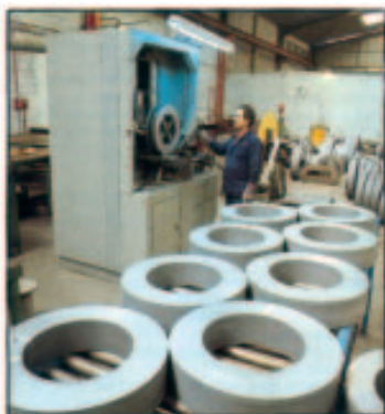
Μηχανή κοπής & περιέλιξης πυρήνων
