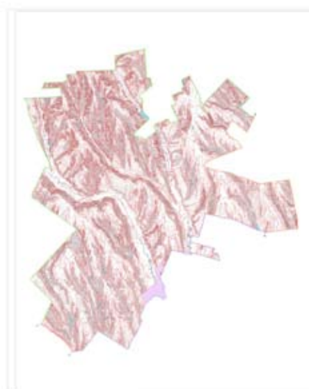
Рис.1. Анализ рельефа по крутизне склонов
