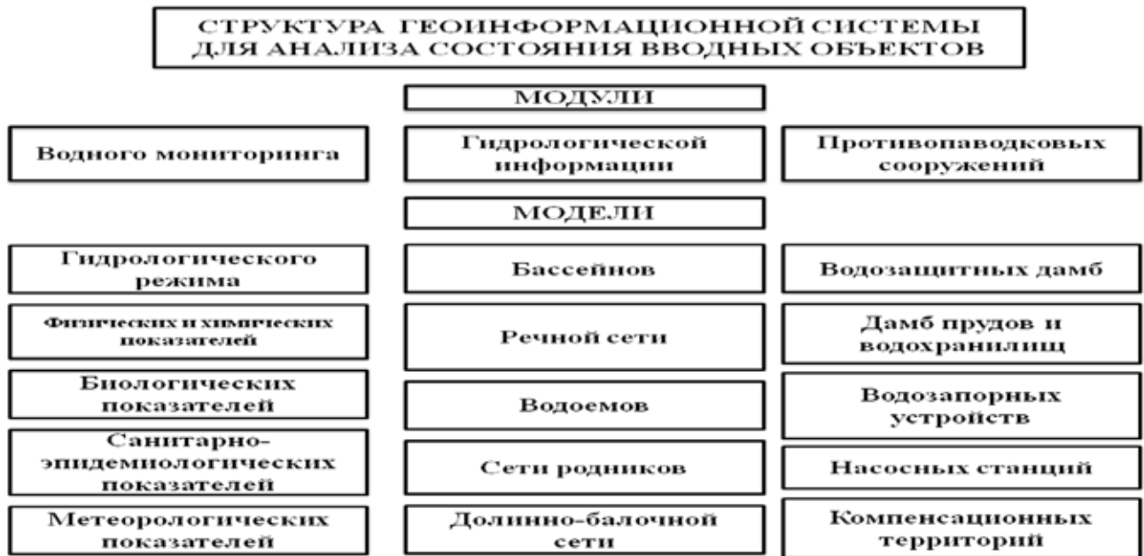
Рис. 2. Структура информационной системы для анализа изменений водных объектов
