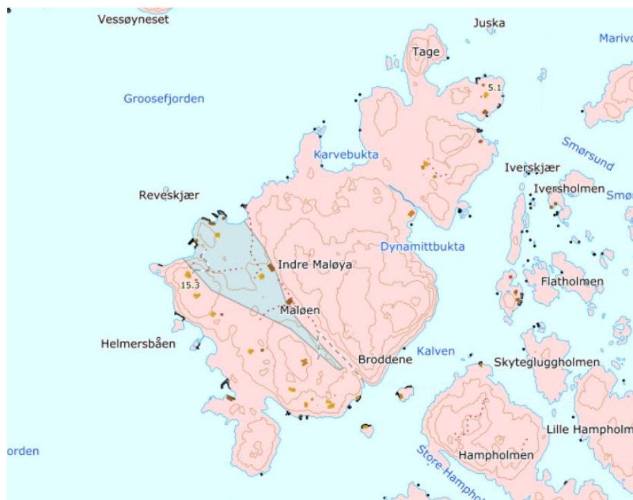
Figur 3. Løsmassekart viser at det meste av øya er vist som kategori «bart fjell», det vil si at mer enn 50 % av arealet er fjell i dagen. Kilen inn fra Reveskjær er vist som «hav- og fjordavsetning og strandavsetning» Kilde: NGU
