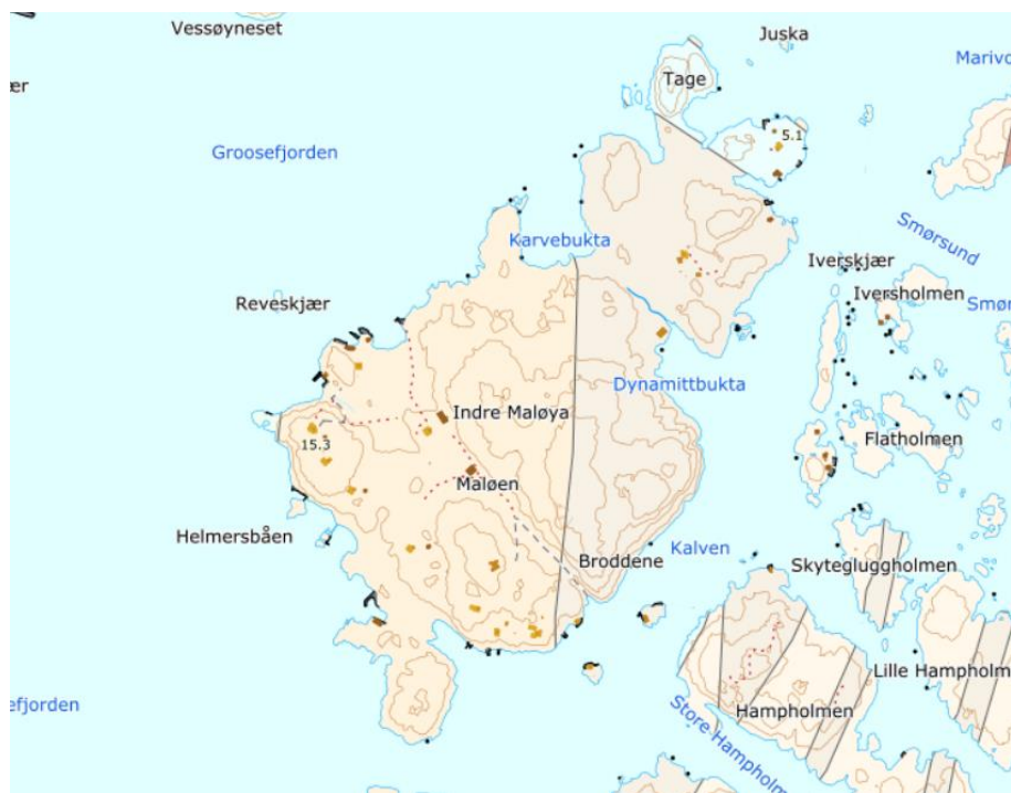
Figur 2. Berggrunnskart N50 viser at nordre del av øya har et felt med kalkspatmarmor, skarn, jernmalm (magnetitt), det østre feltet, inkludert Dynamittbukta, amfibolitt, og vestre del Båndgneis, grå, lokalt med skarn og magnetitt (NGU). Kilde: NGU
