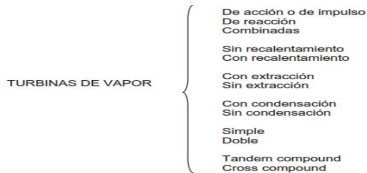
Figura 3.1 Clasificación de turbinas de vapor
