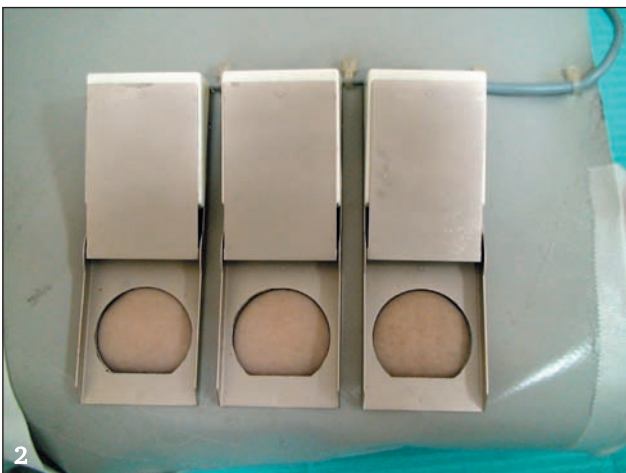
Εικόνες 2, 3 - Πρότυπο με πολλά παράθυρα που κλείνουν χειροκίνητα, όταν οι επιθυμητές δόσεις ακτινοβολίας έχουν επιτευχθεί.
