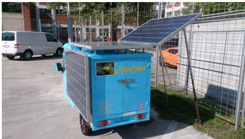
5. ábra: Az egyik napelem parkoláskor felemelhető a megnövelt benapozottság érdekében.
