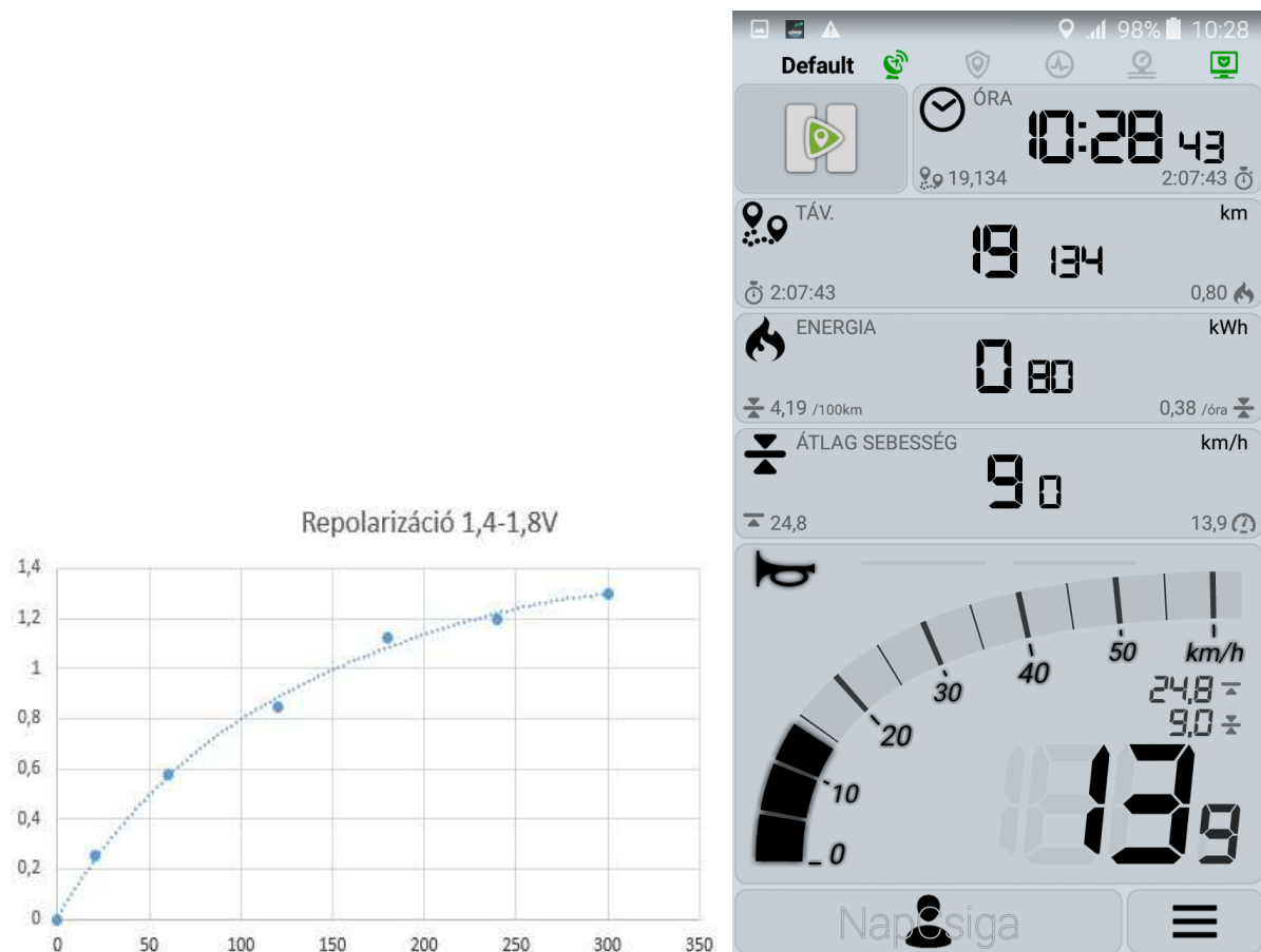
9-10. ábra: A jármű akkumulátorának repolarizációja terhelés után kb. 1,5 V 5 perc alatt (utána már töltés következik); Átlagos terhelés esetén a fogyasztás 4,19kWh/100 km
