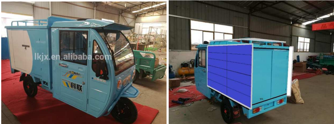
1. ábra: A kiválasztott elektriska jellegű haszonjármű, melynek karosszériáján 3 napelem elhelyezhető.
