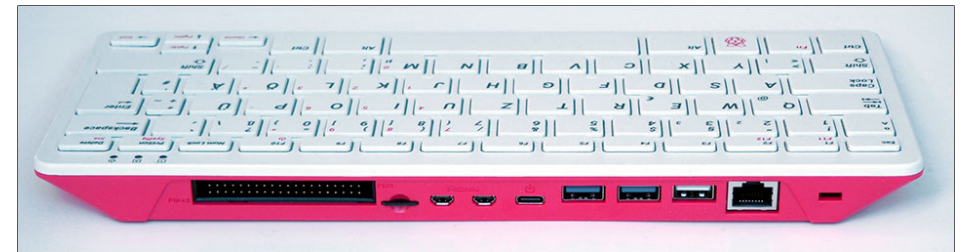
Abbildung 1.5 Die Rückseite mit den Schnittstellen des Raspberry Pi 400: Von links nach rechts: GPIO, SD-Karte, 2x HDMI, USB-C, 2x USB 3.0, USB 2.0 (Maus), Ethernet.
