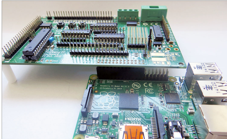
Abbildung 16.3 Das Gertboard kann problemlos auf den Raspberry Pi 2, 3 oder 4 gesteckt werden.
