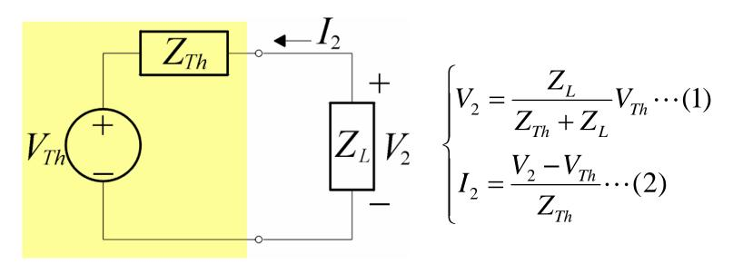
$$\Rightarrow \begin{bmatrix} Z_L & -V_2 \\ 1 & I_2 \end{bmatrix} \times \begin{bmatrix} V_{Th} \\ Z_{Th} \end{bmatrix} = \begin{bmatrix} V_2 Z_L \\ V_2 \end{bmatrix}; \quad \begin{bmatrix} V_{Th} \\ Z_{Th} \end{bmatrix} = \begin{bmatrix} Z_L & -V_2 \\ 1 & I_2 \end{bmatrix}^{-1} \times \begin{bmatrix} V_2 Z_L \\ V_2 \end{bmatrix}.$$
