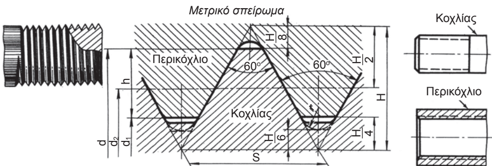
Σχ. 6.14 Σχεδιαστική παράσταση μετρικού σπειρώματος
