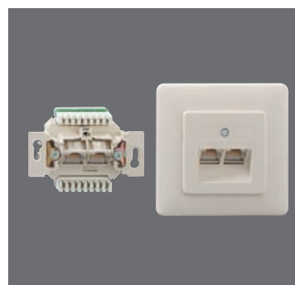
UAE 8/8 (8/8) LSA Up 130 102 16 ● Rabattgruppe 1 2 x 8-polig; 2 x 8 LSA-Kontakte; mit Kunststofftragstegen, Zentralstück und Abdeckplatte; mit Spreizkrallen; perlweiß (ähnlich RAL 1013); 80 x 80 x 30 mm; 53 g
