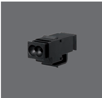
KMK-POF 180 006 00 ● Rabattgruppe 1 POF-Kupplung; Keystone; für Montageadapter KMK-MA Up und andere Keystone-Aufnahmen; Anschluss: 2 x POF 2,2 mm; schwarz (ähnlich RAL 9005); 36 x 14 x 20 mm; 56 g
