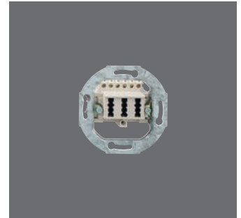
TAE 3x6 NFN Up 0 102 105 03 ● Rabattgruppe 1 3 x 6-polig; 6 Schraubkontakte; mit Spreizkrallen; perlweiß (ähnlich RAL 1013); 70 x 70 x 29 mm; 49 g
