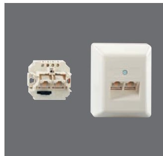
IAE/UAE 2x8 (4) TRS Ap 130 101 40 ● Rabattgruppe 1 2 x 4-polig; 4 Schraubkontakte; perlweiß (ähnlich RAL 1013); 65 x 80 x 26 mm; 39 g
