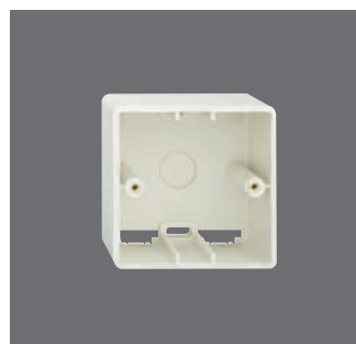
UAE-Cat.5e+6 ApG 135 105 03 ● Rabattgruppe 1 Aufputzgehäuse*; für Up-Bauformen; perlweiß (ähnlich RAL 1013); 80 x 80 x 46 mm; 93 g
