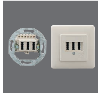
TAE 3x6 NFN Up 102 102 03 ● Rabattgruppe 1 3 x 6-polig; 6 Schraubkontakte; mit Zentralstück und Abdeck- platte; mit Spreizkrallen; perlweiß (ähnlich RAL 1013); 80 x 80 x 31 mm; 67 g
