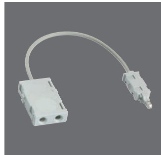
Prüfschnur AsLe LSA-Plus 290 322 ● Rabattgruppe 1 Prüfschnur mit Prüfstecker für AsLe LSA-Plus; 2-polig mit 2 Steckbuchsen; Kabellänge 200 mm; 12 g
