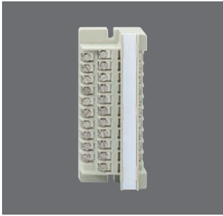
AsLe A 10 S/S 260 033 ● Rabattgruppe 1 10 DA; Schraub-/Schraubkontakte, 96 mm Befestigungsabstand; mit einem Beschriftungsstreifen; 45 x 106 x 23 mm; 100 g
