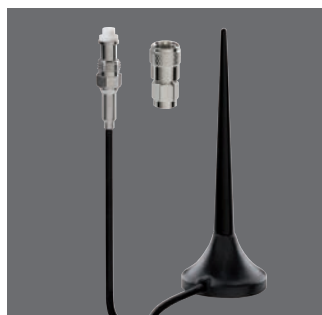
FME-Magnethaftfußantenne 700 902 602 ● Rabattgruppe 2 bestehend aus GSM-Antenne und einem FME-SMA-Adapter; das Set wird benötigt, wenn man beim TC GSM/GPS die interne SMA-Stabantenne durch eine externe FME-Magnethaftfußantenne ersetzen möchte; Kabellänge 3000 mm; 70 g
