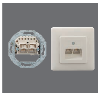
IAE/UAE 2x8 (4) Up 130 102 11 ● Rabattgruppe 1 2 x 4-polig; 4 Schraubkontakte; mit Zentralstück und Abdeck- platte; mit Spreizkrallen; perlweiß (ähnlich RAL 1013); 80 x 80 x 31 mm; 59 g
