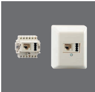
IAE/UAE 8 (6)-TAE 6 F+N Ap 133 101 01 ● Rabattgruppe 1 2 x 6-polig; 2 x 6 Schraubkontakte; perlweiß (ähnlich RAL 1013); 65 x 80 x 26 mm; 45 g
