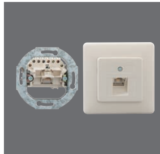
IAE/UAE 8 (4) Up 130 102 09 ● Rabattgruppe 1 4-polig; 4 Schraubkontakte; mit Zentralstück und Abdeck- platte; mit Spreizkrallen; perlweiß (ähnlich RAL 1013); 80 x 80 x 31 mm; 58 g
