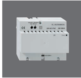
SVR 48 V PoE 235 103 01 ● Rabattgruppe 2 PoE-Spannungsversorgung für REG-Montage; Ausgangsleistung: 48 W, für bis zu 3 PoE-Geräte (Klasse 0–3); Nennbetriebsspannung: 100–240 V~/50–60 Hz; lichtgrau (ähnlich RAL 7035); 108 x 95 x 56 mm = 6 TE; 300 g
