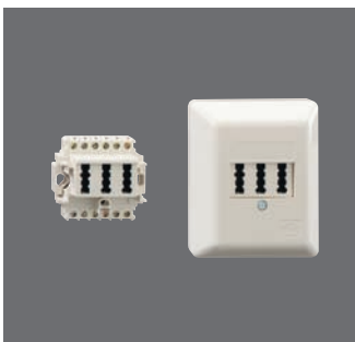
TAE 2x6/6 NFF Ap 103 101 10 ● Rabattgruppe 1 3 x 6-polig; 2 x 6 Schraub- kontakte; perlweiß (ähnlich RAL 1013); 65 x 80 x 27 mm; 45 g
