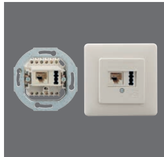
IAE/UAE 8 (6)-TAE 6 F+N Up 133 102 01 ● Rabattgruppe 1 2 x 6-polig; 2 x 6 Schraubkontakte; mit Zentralstück und Abdeckplatte; mit Spreizkrallen; perlweiß (ähnlich RAL 1013); 80 x 80 x 31 mm; 67 g
