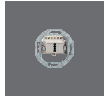
TAE 6 F+N Up 0 100 105 51 ● Rabattgruppe 1 6-polig; 6 Schraubkontakte; mit Spreizkrallen; perlweiß (ähnlich RAL 1013); 70 x 70 x 29 mm; 45 g
