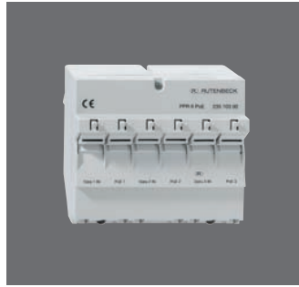
PPR 6 PoE 235 103 00 ● Rabattgruppe 2 PoE-Patchpanel für REG-Montage; Midspanlösung; 3 x RJ45-Port Dateneingänge, 3 x RJ45-Port Ausgänge, Daten + PoE; geeignet für 10/100 Mbit/s; Nennbetriebsspannung: 48 V DC; Leistungsaufnahme 1 A; lichtgrau (ähnlich RAL 7035); 108 x 95 x 56 mm = 6 TE; 190 g
