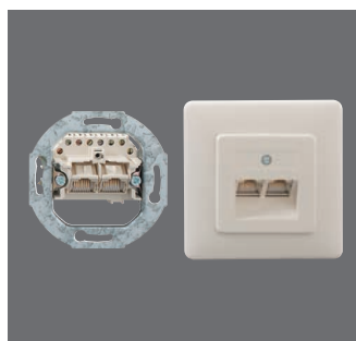
UAE 2x8 (8) Up 130 102 12 ● Rabattgruppe 1 2 x 8-polig; 8 Schraubkontakte; mit Zentralstück und Abdeck- platte; mit Spreizkrallen; perlweiß (ähnlich RAL 1013); 80 x 80 x 31 mm; 61 g
