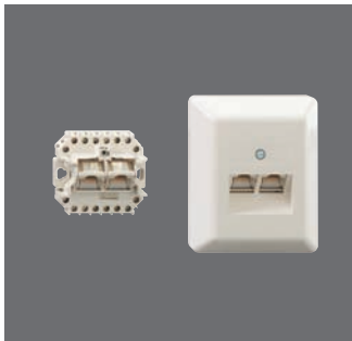
UAE 8/8 (8/8) Ap 130 101 10 ● Rabattgruppe 1 2 x 8-polig; 2 x 8 Schraubkontakte; perlweiß (ähnlich RAL 1013); 65 x 80 x 26 mm; 44 g
