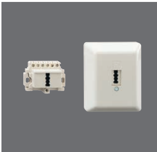
TAE 6 F+N Ap 100 101 51 ● Rabattgruppe 1 6-polig; 6 Schraubkontakte; perlweiß (ähnlich RAL 1013); 65 x 80 x 27 mm; 42 g
