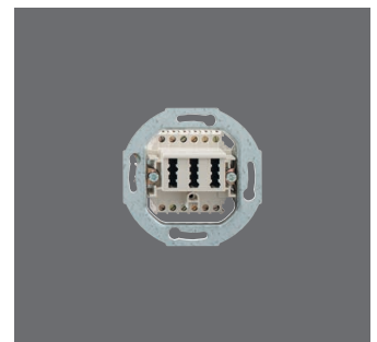
TAE 2x6/6 NFF Up 0 103 105 10 ● Rabattgruppe 1 3 x 6-polig; 2 x 6 Schraub- kontakte; mit Spreizkrallen; perlweiß (ähnlich RAL 1013); 70 x 70 x 29 mm; 53 g
