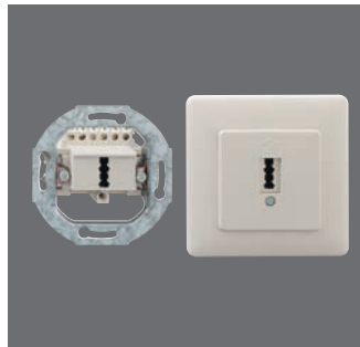
TAE 6 F+N Up 100 102 51 ● Rabattgruppe 1 6-polig; 6 Schraubkontakte; mit Zentralstück und Abdeck- platte; mit Spreizkrallen; perlweiß (ähnlich RAL 1013); 80 x 80 x 31 mm; 60 g
