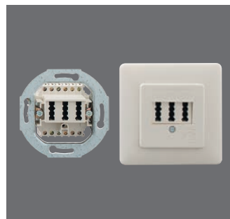
TAE 2x6/6 NFF Up 103 102 10 ● Rabattgruppe 1 3 x 6-polig; 2 x 6 Schraub- kontakte; mit Zentralstück und Abdeckplatte; mit Spreizkrallen; perlweiß (ähnlich RAL 1013); 80 x 80 x 31 mm; 68 g
