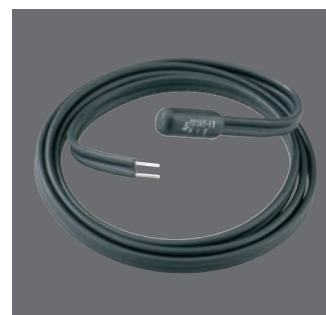
Temperatursensor 700 802 201 ● Rabattgruppe 2 Auflösung 1 °C; B-Wert 3435 K ± 1 %; 10 kΩ bei 25 °C; schwarz (ähnlich RAL 9005); 600 mm; 6 g
