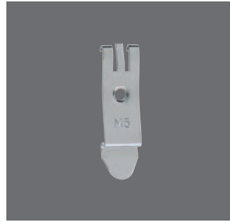
Hutschienenadapter 221 012 ● Rabattgruppe 1 Hutschienenadapter zur Befestigung von Anschluss- leisten, Montagebügeln oder Anschlussdosen; mit Schraube M5; 14 x 50 x 7 mm; 5 g
