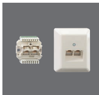
UAE 8/8 (8/8) LSA Ap 130 101 12 ● Rabattgruppe 1 2 x 8-polig; 2 x 8 LSA-Kontakte; perlweiß (ähnlich RAL 1013); 65 x 80 x 26 mm; 45 g
