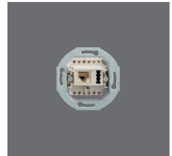
IAE/UAE 8 (6)-TAE 6 F+N Up 0 133 104 01 ● Rabattgruppe 1 2 x 6-polig; 2 x 6 Schraubkontakte; mit Spreizkrallen; perlweiß (ähnlich RAL 1013); 70 x 70 x 29 mm; 51 g
