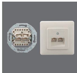
IAE/UAE 8/8 (4/4) Up 130 102 13 ● Rabattgruppe 1 2 x 4-polig; 2 x 4 Schraub- kontakte; mit Zentralstück und Abdeckplatte; mit Spreizkrallen; perlweiß (ähnlich RAL 1013); 80 x 80 x 31 mm; 63 g
