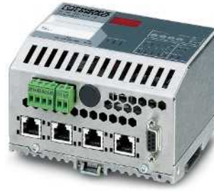
PROFINET-PROFIBUS-Proxy für PC WORX-Steuerungssysteme
