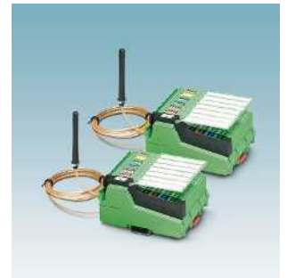
Bluetooth-Funkmodule (2,4 GHz) Wireless-Multiplexer mit Antennen
