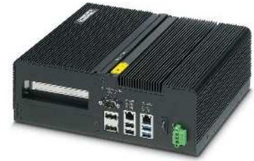
Box-PC mit Intel® Core™ i3-4010U-Technologie und PCI/e-Slot
