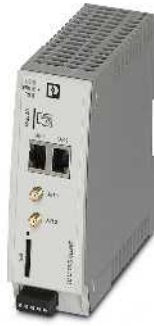
Cloud Client für Zugriff über 4G-LTE-Mobilfunk (Europa-Version)
