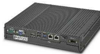
Box-PC mit Intel® Celeron® -N2930-Technologie und PCI-Slots
