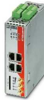
4G-LTE-Mobilfunk-Router mit Firewall und VPN, integrierter 4-Port Switch
