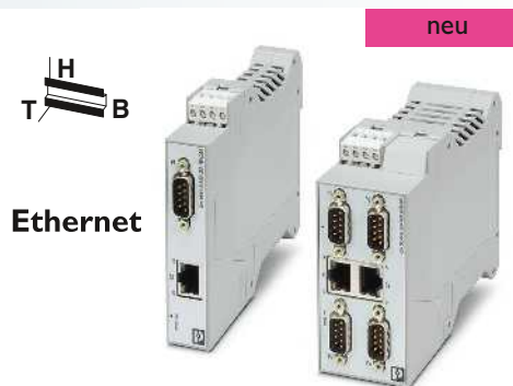
Geräte-Server zum protokolltransparenten Übertragen serieller Daten über Ethernet
