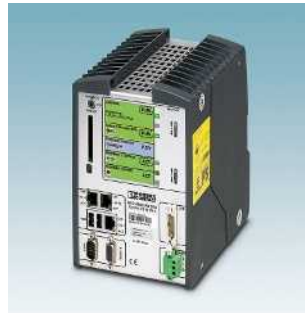
Sichere PROFIsafe-Steuerung Seite 309
