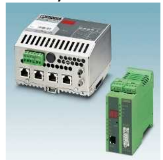
Proxies als Bindeglied zwischen PROFINET-Netzwerken und anderen Feldbussystemen Seite 444
