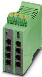
Hub mit RJ45-Ports
