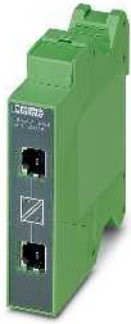
Übertragungsraten bis 100 MBit/s, zweimal RJ45-Anschluss
