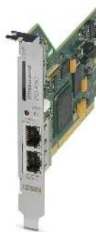
Router mit Firewall für PCI, optional mit VPN
