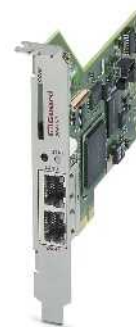
Router mit Firewall und VPN für PCIe
