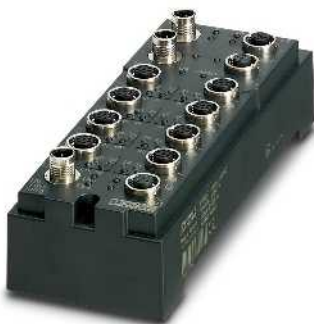
16 digitale Eingänge, 16 digitale Ausgänge und erweiterte Diagnose
