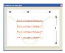
Die Eingabe von bis zu 128 Stützstellen ermöglicht eine exakte Definition der Messstellengeometrie. Dadurch wird eine hochgenaue Ermittlung des Abflusses auch bei komplexen Querschnitten möglich.
