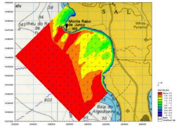
Fig. 12 - Propagação da agitação. Rumo:  $202,5^{\circ}$ ; Tm = 10 s; H = 2 m
