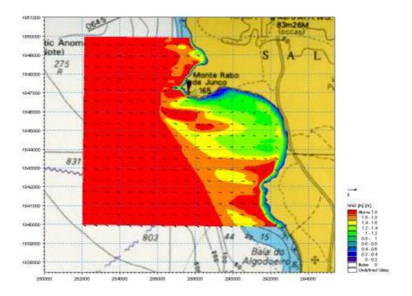
Fig. 10 – Propagação da agitação. Rumo:  $292.5^{\circ}$ ; Tm = 10 s; H = 2 m
