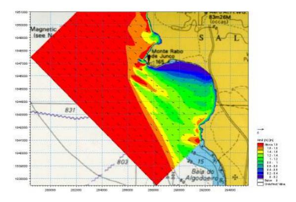
Fig. 9 – Propagação da agitação. Rumo:  $315^{\circ}$ ; Tm = 10 s; H = 2 m
