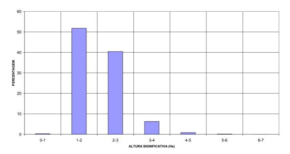
Fig. 7- Distribuição da altura significativa das ondas
