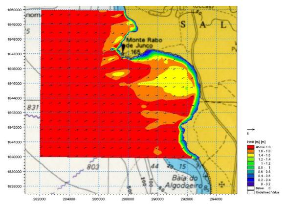
Fig. 11 - Propagação da agitação. Rumo:  $247,5^{\circ}$ ; Tm = 10 s; H = 2 m
