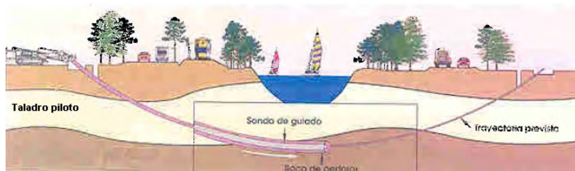
Perforación piloto en perforación horizontal dirigida tipo. Fuente: Red Eléctrica.
