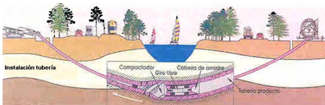
Instalación de tubos en perforación horizontal dirigida tipo. Fuente: Red Eléctrica.
