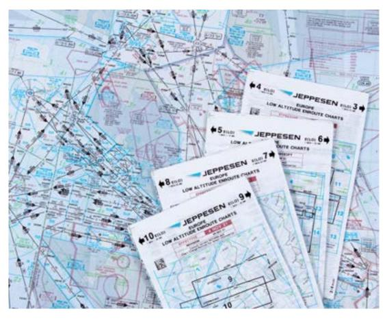
Die E(LO) IFR Streckenkarten (Enroute Charts) von Jeppesen für den unteren Luftraum (Low) sind zweifarbige Karten im Maßstab 1:1.500.000. Sie zeigen alle Funknavigationsanlagen und Frequenzen der Bodenanlagen sowie Sperrgebiete und Streckenführung. Auf Vorder- und Rückseite ist je eine Karte.
