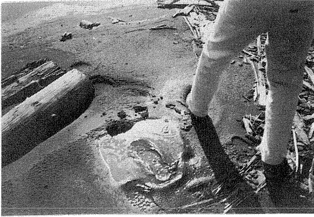
写真-3.1.8 第3埠頭 貯木場での噴砂 釧路沖地震の時と同様、今回もこの地区で大量の噴砂が発生した。雨水で飽和していたため写真のとおり、噴砂を4、5回踏んだだけで簡単に液状化した。
