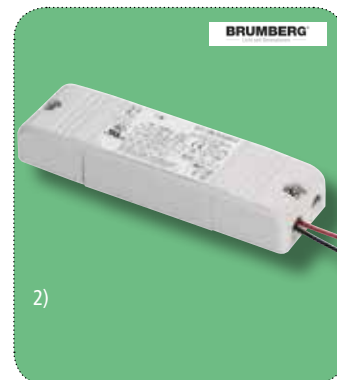
2) LED Konverter 1-15W, 350mA Konstantstrom (Reihenschaltung), prim. 100-240VAC, Frequenz 50-60Hz, Maße 115x34x19mm
