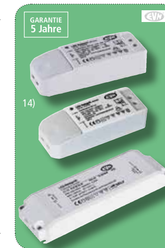
14) LED-Netzgerät dimmbar prim. 220-240VAC, sec. 350mA, weiß, dimmbar mit Phasen- u. -abschnittsdimmer, IP20, SK II, SELV
