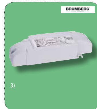
3) LED Konverter Für den Einsatz von 2 Leuchten á 6,6W, 10,5-18W, sec. 350mA Konstantstrom (Reihenschaltung), prim. 220-240VAC, Frequenz 50-60Hz, dimmbar über Phasen-/abschnitt, LxBxH 140x44x30mm
