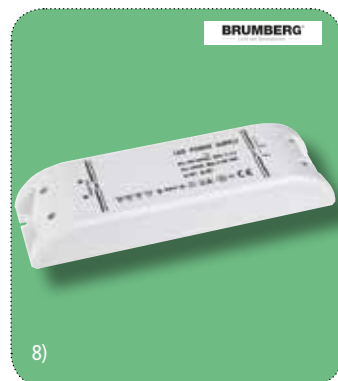
8) LED-Netzgerät 20-75W, sec. 24VDC, prim. 200-240VAC, Frequenz 50-60Hz, nicht dimmbar, inkl. Zulentlastung, LxBxH 200x63x30mm
