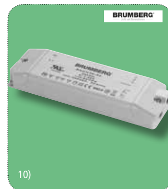
10) LED-Netzgerät 30W, sec. 24VDC, prim. 90-264VAC, Frequenz 47-63Hz, nicht dimmbar, LxBxH 160x50x22mm, IP20
