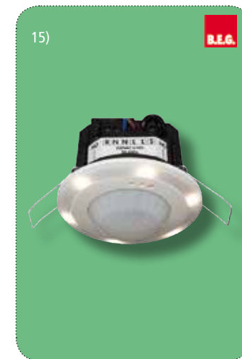
15) LED-Präsenzmelder 2300W, 110-240VAC, 50/60Hz, weiß, mit integrierter LED-Beleuchtung als Orientierungs- oder Nachtlcht, 1 Schaltkanal, 360° Erfassungsbereich, 10 m Ø Reichweite, IP20, SK II
