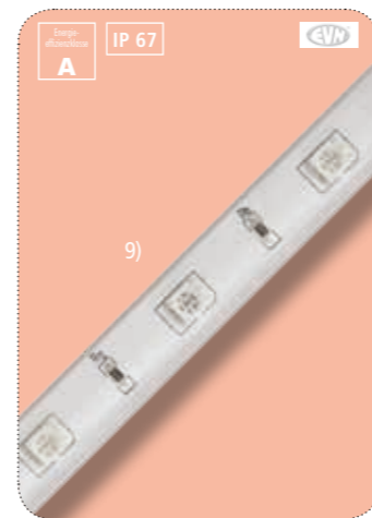
9) LED-Stripe 30W, 150 LEDs, RGB, 140lm/m, 24V/DC, Platinenfarbe weiß, L 5m Rolle, BxH 14x7mm, Abstand 33,33mm, mit 3M Klebeband, wärmebeständig, UV-beständig, 2-Step-MacAdam, alle 10cm kürzbar, dimmbar, Winkel 120°, IP67, SK III, EEK A 494 3745 190,30 €
