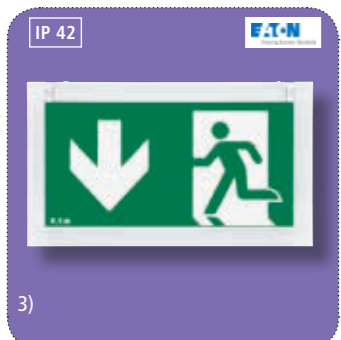
3) Einzelbatterieleuchte CrystalWay weiß, für Wand- und Deckenmontage, autom. Funktions- und Betriebsdauererster, Notlichtbetriebsdauer (1, 3 oder 8 Std.) wählbar, IP42, inkl. Piktogramm-Set (Pfeil rechts/links/unten/oben/BL), inkl. LED
