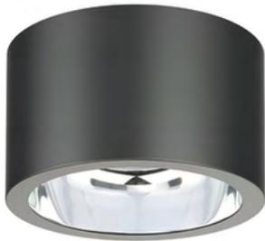
13W, 200-240V/AC, Aluminiumgehäuse, Kunststoff opal, Strahlungswinkel 60°, Phasen-/abschnitt dimmbar, Blendwert UGR≤19, Lichtfarbe 5700K, 4000K oder 3000K mit Schalter einstellbar, Ø=213mm, H=129mm.
