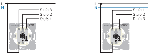
Bild 1: 3-Stufenschalter mit Nullstellung [Best.-Nr. 3861] / 3-Stufenschalter ohne Nullstellung [Best.-Nr. 386101]
