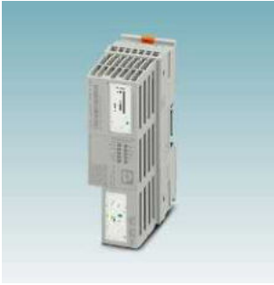
PLCnext Control AXF 2152 – Steuerung für PLCnext Technology Seite 10
