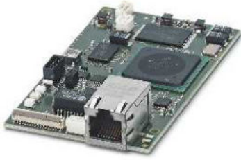
Embedded Router/Firewall mit VPN
