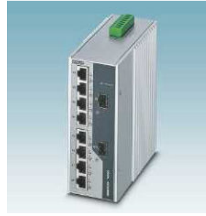
Unmanaged Power-over-Ethernet-Switches in IP30 und IP67 Seite 302
