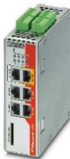
Router mit intelligenter Firewall und integriertem Switch
