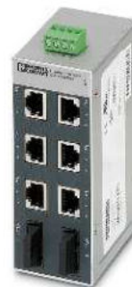
6 RJ45-Ports und 2 LWL-Ports
