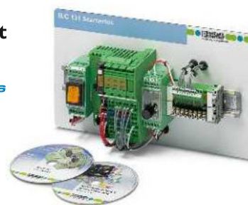
Testaufbau für den Schnelleinstieg in INTERBUS-Automation
