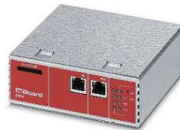
Router mit intelligenter Firewall, optional mit VPN
