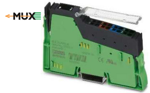
24-V-DC-Versorgung an U_M und U_S
