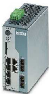
6 / 5 RJ45-Ports und 2 / 3 LWL-Ports
