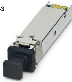
Glasfaser, für Übertragungreichweiten bis 40 km
