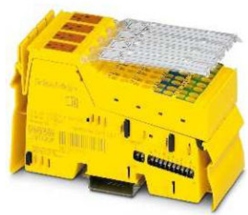
Verbindung zu max. 16 sicheren Ein-/Ausgangsmodulen
