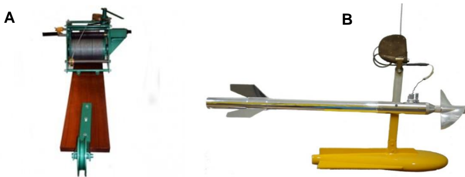
Figura 3. Equipamentos utilizados durante o monitoramento Hidrossedimentológico e batimétrico da PCH Verde 4A, onde A) Guincho fluviométrico e B) Molinete fluviométrico. Em julho de 2019.
