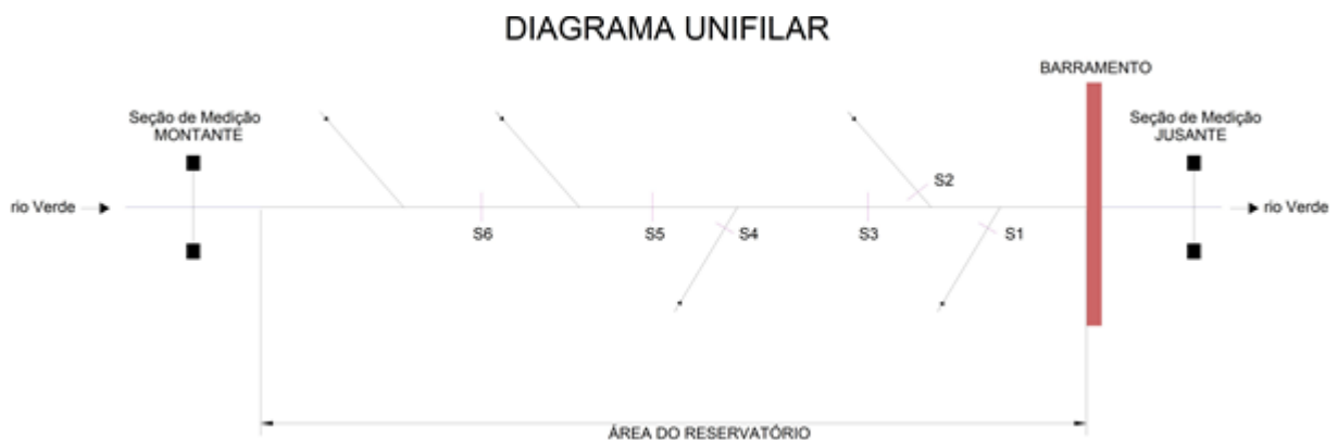
Figura 8. Diagrama unifilar da localização das seções transversais do monitoramento hidrossedimentológico e batimétrico da PCH Verde 4A, Água Clara, MS. Julho de 2019.
