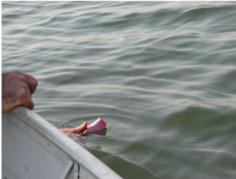
Figura 6. Coleta de água superficial para o monitoramento de fitoplâncton no reservatório intermediário, PCH Verde 4A, rio Verde, Água Clara, MS.
